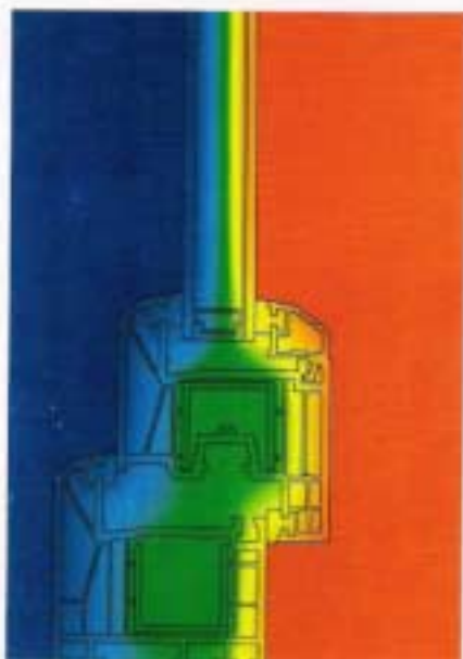
Valore termico: La foto mostra un ottimo percorso delle curve isofermiche.
